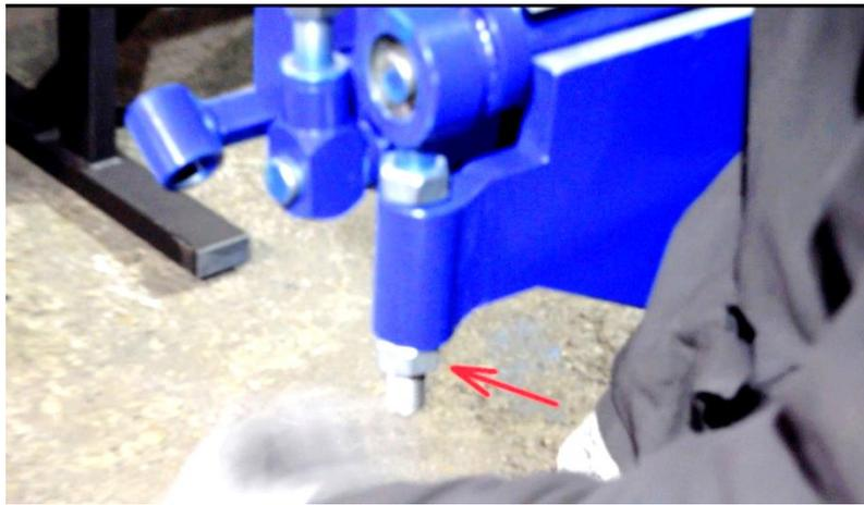
8. Поверните вертикально поворотную балку, для установки пневмостойки.
