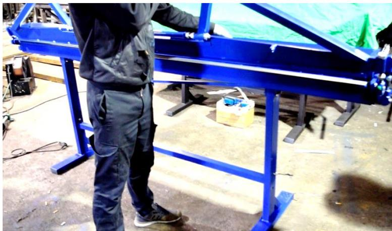
9. Закрепите пневмостойку на поворотной балке,
