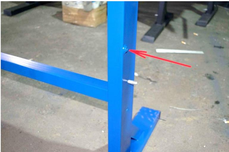
5. Соедините ноги станка с связывающей их балкой 4 болтами с гайками.
