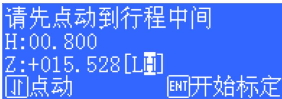
Во время калибровки сервопривода двигатель будет колебаться вперед и назад с небольшой амплитудой. **Поэтому необходимо сначала переместиться к середине хода, чтобы не допустить выхода за пределы диапазона хода при вибрации.** Затем нажмите <ENT>, чтобы начать калибровку.
