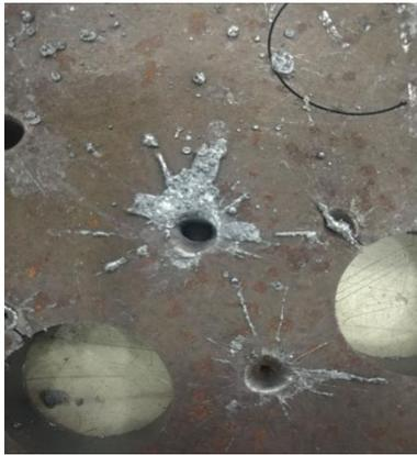
Примечание. Как правило, прямыми способами замедления взрывной обработки являются увеличение времени пробивки и постепенного времени, а также уменьшение рабочего цикла и частоты.
