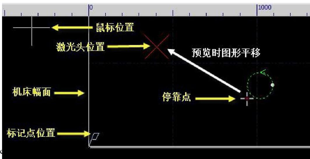
Если фактическому положению лазерной головки на станке, проверьте правильность исходного положения станка и исправьте его через «ЧПУ» -> «Возврат в исходное положение». Если после предварительного просмотра обнаруживается, что вся или часть графики находится за пределами формата станка, это означает, что диапазон хода может быть превышен во время обработки.
